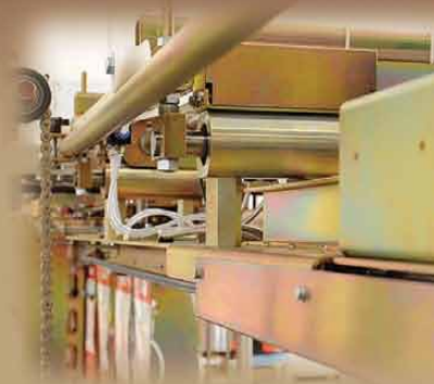
Sellador de la parte superior de la bolsa Modelo 2090
