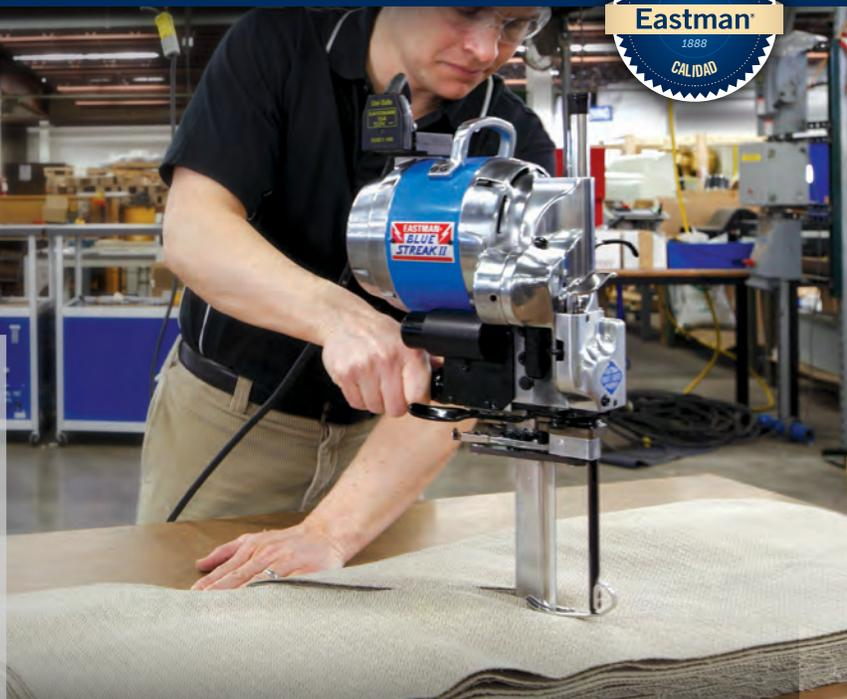
Como norma de la industria desde 1888, las máquinas de cuchilla recta Eastman están diseñadas con tecnología de corte de vaivén a alta velocidad para cortar la gama más diversa de telas tradicionales, modernas e industriales del mercado actual.
